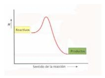
Energía de activación de la reacción directa, energía de activación de la reacción inversa, energía del complejo activado y  $\Delta H$ . Deduzca si se trata de un proceso endotérmico o exotérmico.
