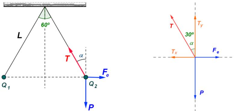
Las esferas determinan un triángulo equilátero, por lo que  $d = L = 0,3 \text{ m}$
